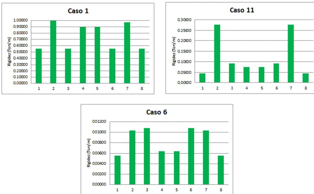
Figura 67. Gráficos de variación de la rigidez en la superestructura (Sector cercha)
