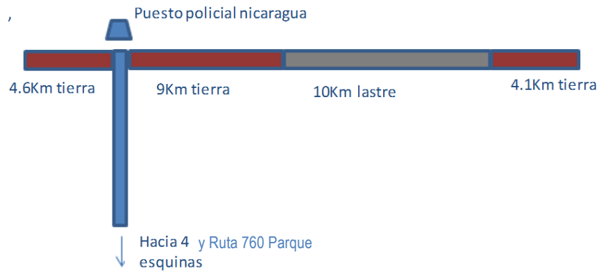
Diagrama N°6. Detalle de acabado existente en los tramos recorridos en esta sección de la trocha .
