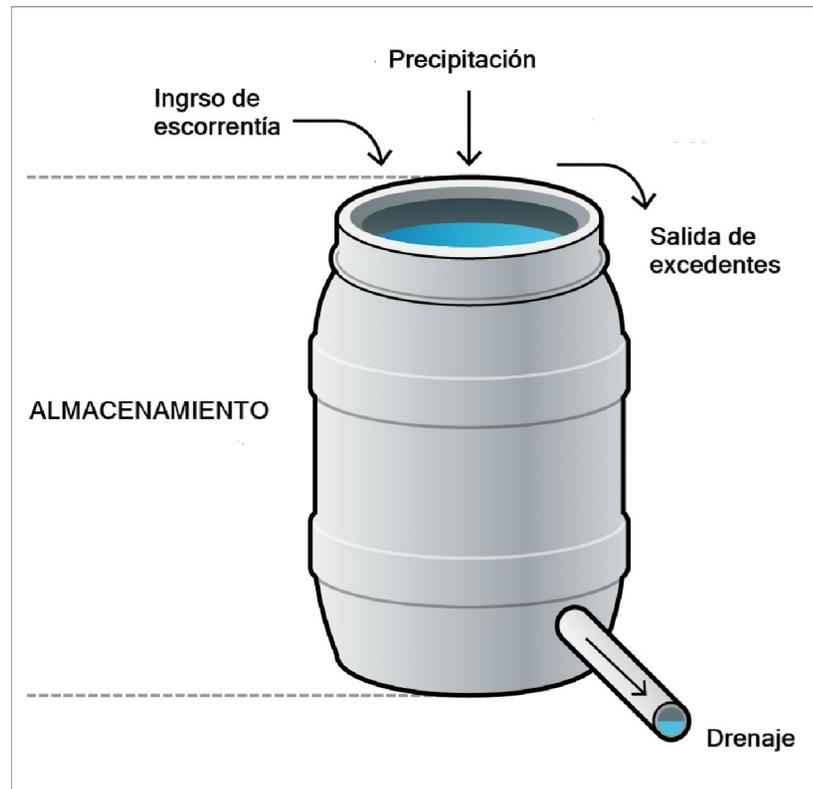
Figura 9.17. Sistema de amortiguamiento individual por medio de estaciones, EPA, 2022
