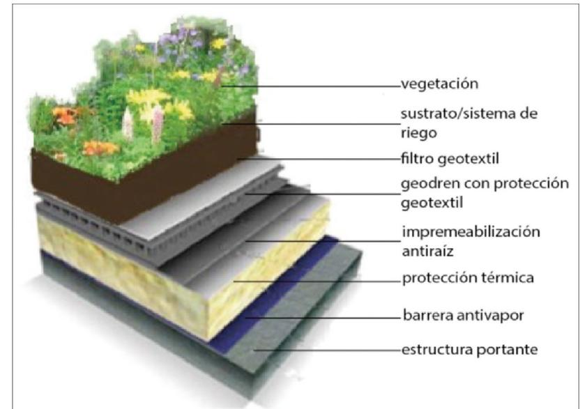
Figura 9.20. Estructura para un techo verde semi intensivo
