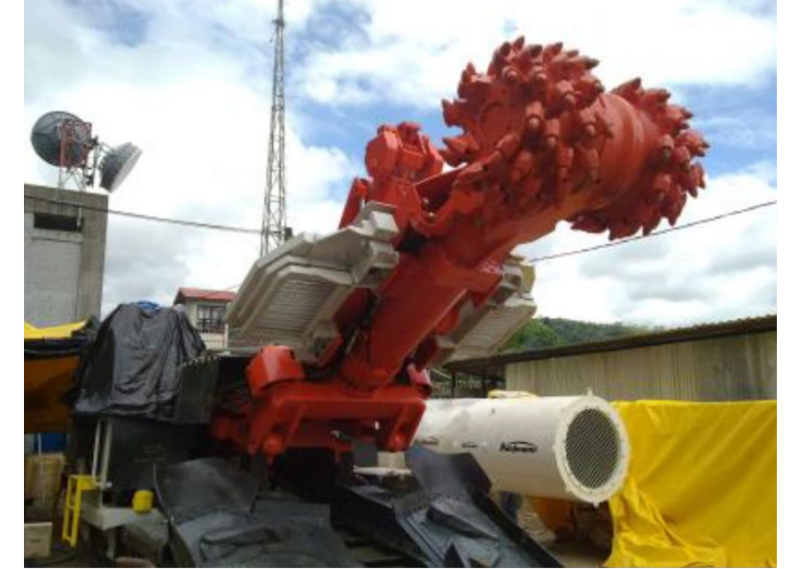
Fotografía 14. Rozadora marca Sanvik, utilizada en el proyecto de ampliación de la planta Cachí.
