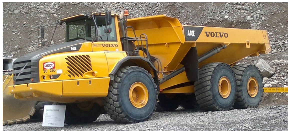
Fotografía 32. Vagoneta articulada para la extracción de escombros.
