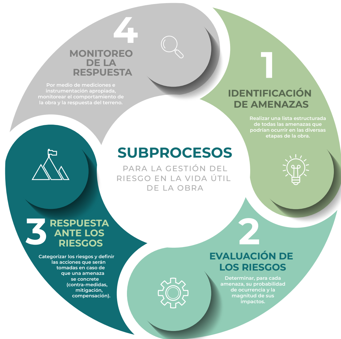
Figura 17. Subprocesos para la gestión del riesgo en la vida útil de la obra.
