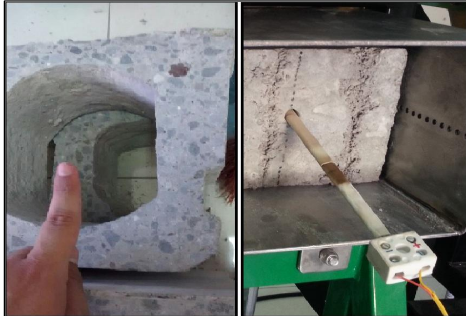
Imagen 43. Colocación de un termopar tipo K para la medición de la temperatura del aire dentro de las losas de entresijos estudiados
