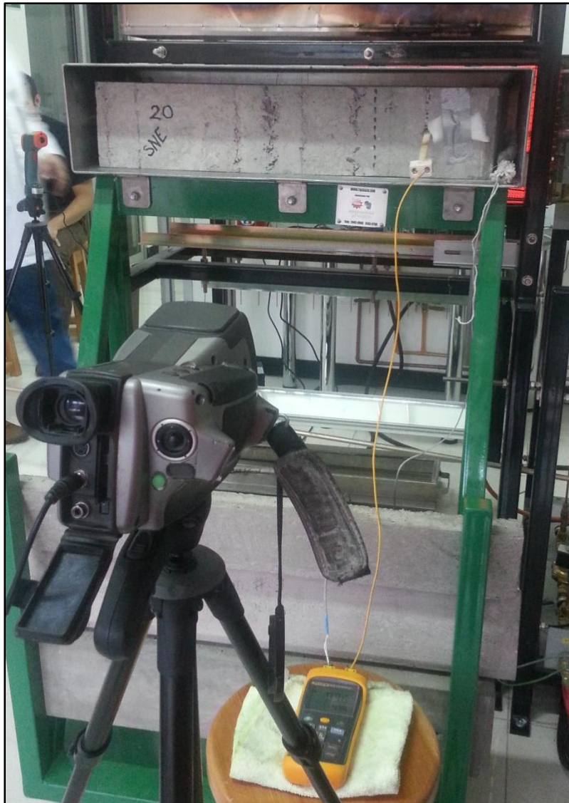
Imagen 44. Monitoreo de la temperatura de la superficie no expuesta mediante un equipo termográfico
