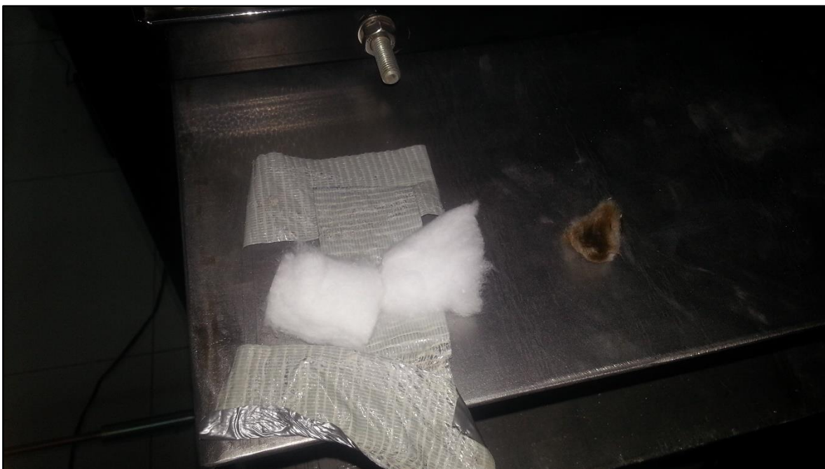
Imagen 57. Carbonización de los bastos de algodón colocados en la superficie no expuesta de las losas de 8 cm de espesor.
