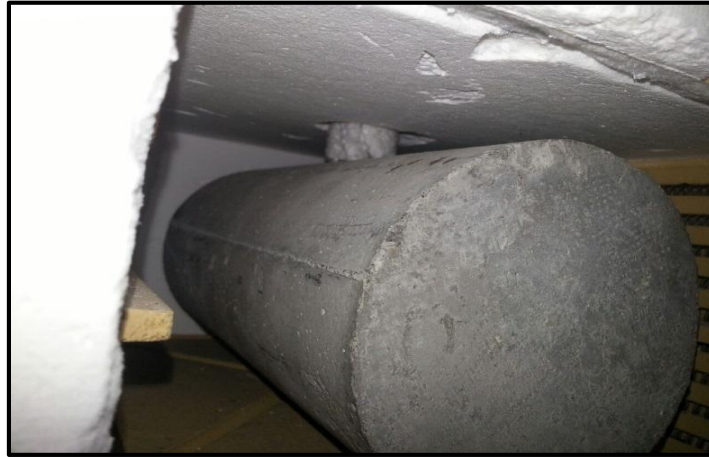
Imagen 77: Montaje de los termopares para el trazo de las curvas de la imagen 74
