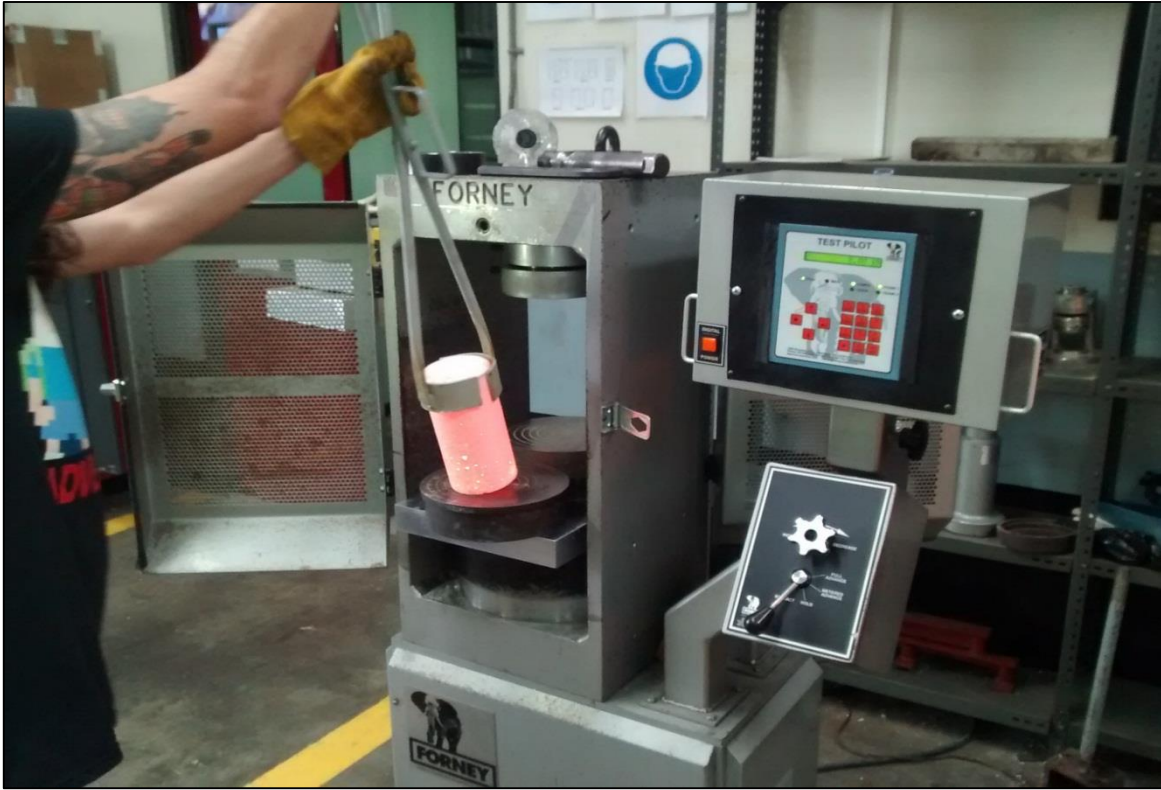
Imagen 85: Extracción de cilindros antes de ser fallados.
