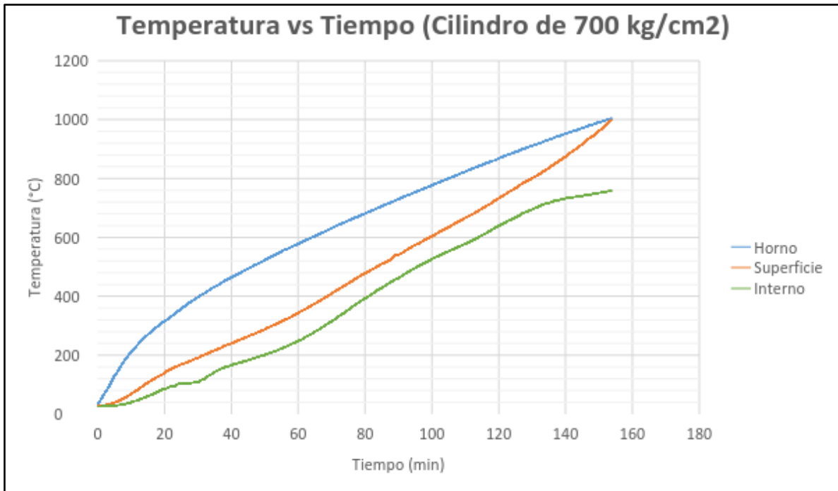
Imagen 74: Temperatura vs tiempo para la resistencia de 700 kg/cm 2
