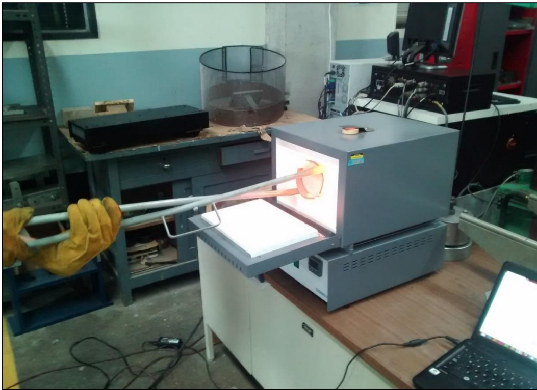
Imagen 82: Extracción de cilindros antes de ser fallados.
