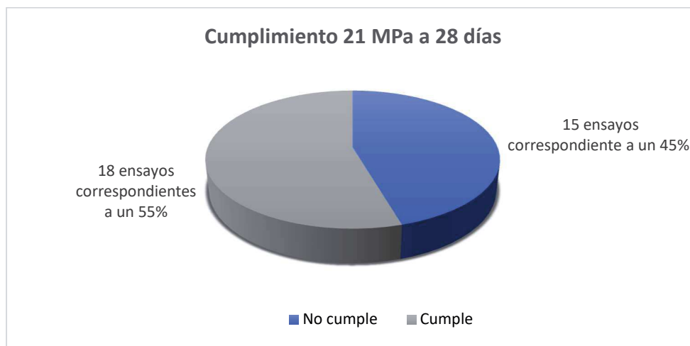
Gráfico 2 Porcentaje de cumplimiento de resistencia a la compresión de especímenes de concreto
